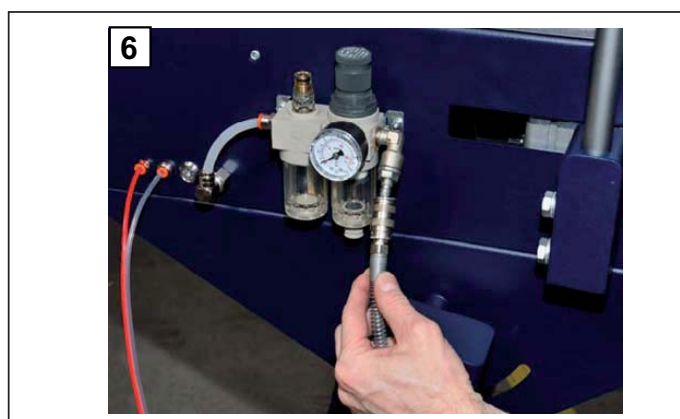
6. Inserire l'alimentazione pneumatica e regolare la pressione, almeno 6 bar, verificandone il valore sul manometro.
