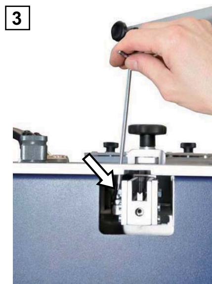
3. Rimuovere la vite che fissa il magazzino all'attuatore pneumatico spingi punti
