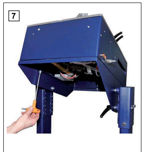
7. Posizionare la macchina sulla culla e unire inserendo 3 viti a brugola, nei punti indicati dalle frecce
